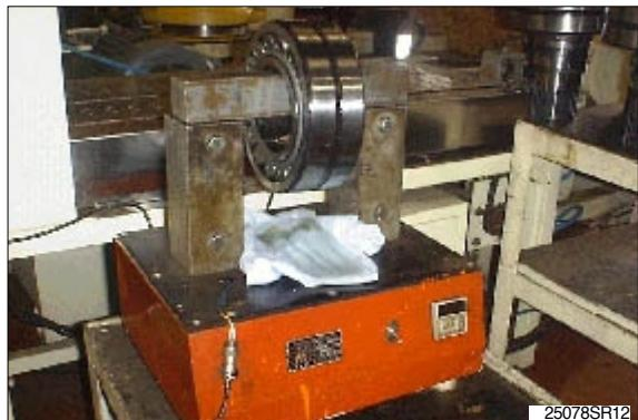
Demagnetize roller bearing(4) using demagnetizing machine.
