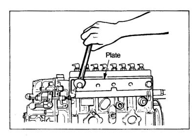
(d) Install the injection pump in special tool(Universal Vice).
