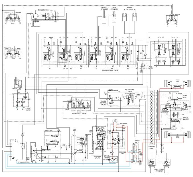
11. FRONT AND REAR AXLE BRAKE SYSTEM (SERVICE BRAKE)
